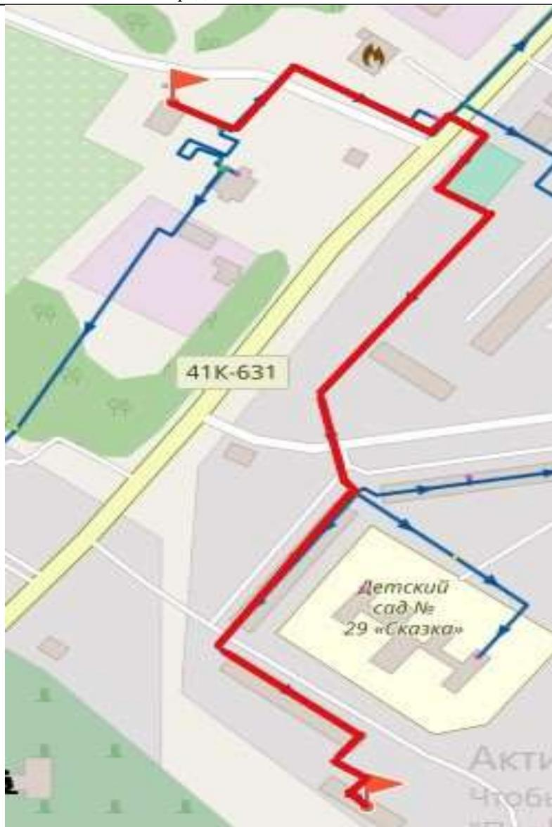
На участке от котельной до дома №28, происходит падение напора в Т/с на 6,053м, располагаемый напор у потребителя составляет 30,73м.
