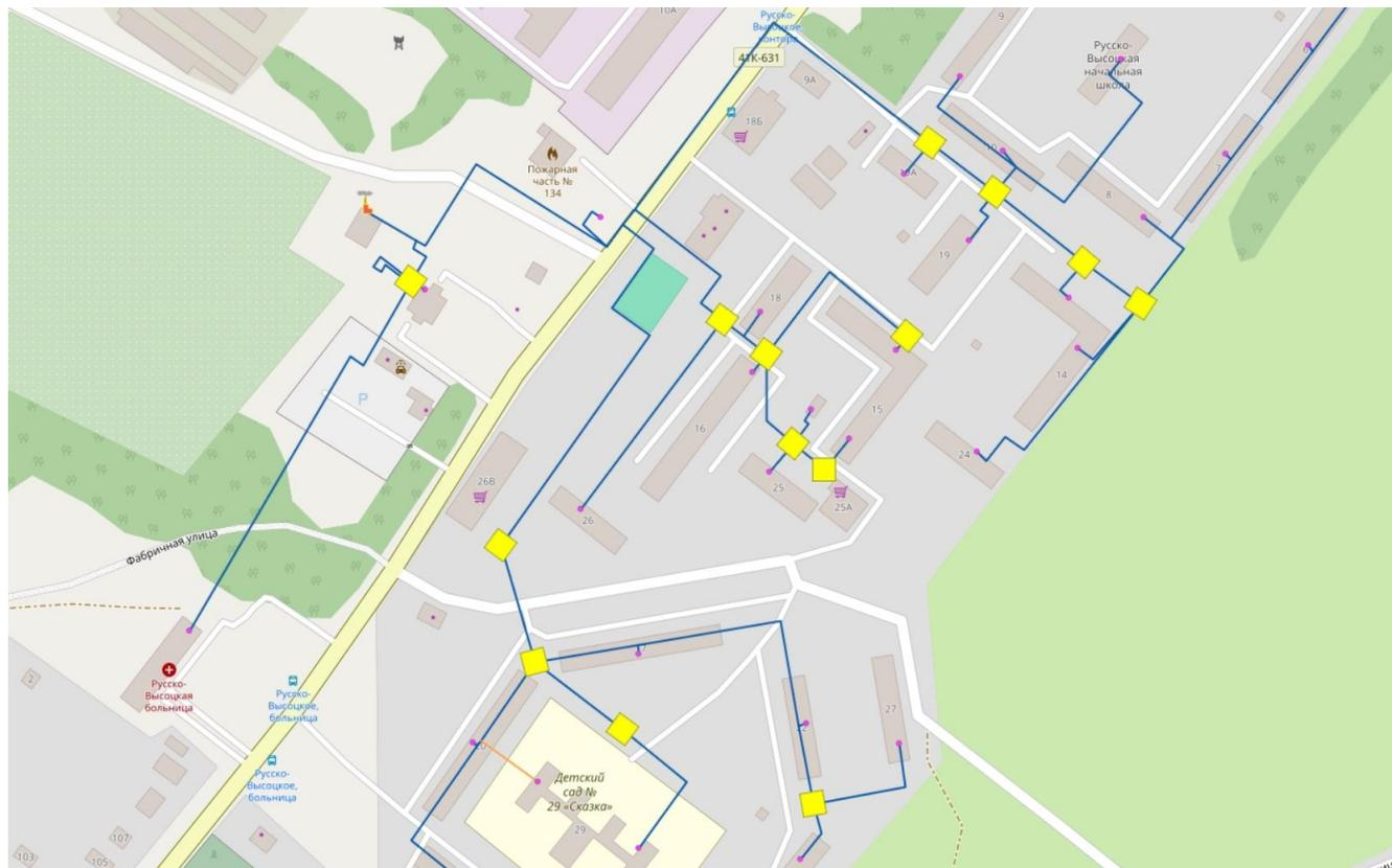
**Рисунок 5 Схематичное обозначение тепловых камер Русско-Высоцкого сельского поселения**
